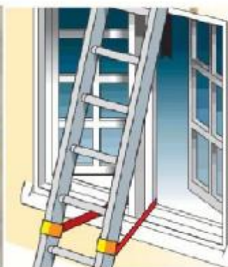
شکل ۸- نحوه تکیه‌گاه فوقانی نردبان یک طرفه
